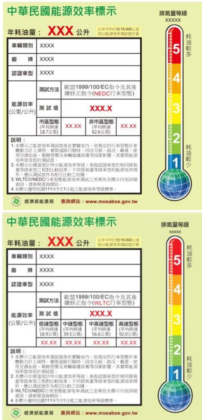
圖 1、汽車(小客車、小貨車、小客貨兩用車)不同行車型態能源效率標示格式圖例
