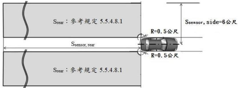
5.5.4.8.3 於車輛每次新引擎啟動/運轉循環後(非自動執行，例如：怠速熄火系統之作動)，ACSF 類型 C 功能應禁止車輛進行變換車道操控，直到系統至少偵測到一次距離大於規定5.5.4.8.1申請者所宣告之最短距離  $S_{rear}$  外之移動物體。
